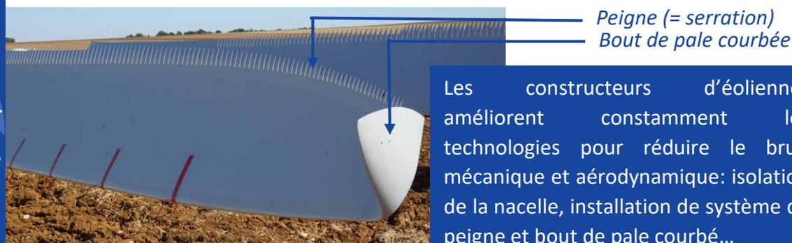
Les constructeurs d'éoliennes améliorent constamment les technologies pour réduire le bruit mécanique et aérodynamique: isolation de la nacelle, installation de système de peigne et bout de pale courbé...
